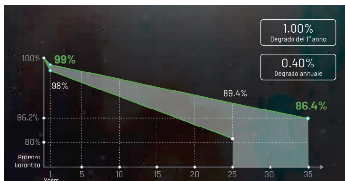
Figura 5 - Grafico di decadimento del rendimento di un modulo bifacciale di tipo TOPCon (nella porzione più chiara la fascia garantita. (Fonte: Sonnex energie).
