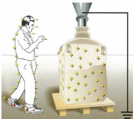
Figura 3 - Scarica capacitiva tra un materiale conduttivo carico di elettricità statica, in un contenitore isolante, con un oggetto conduttivo.
