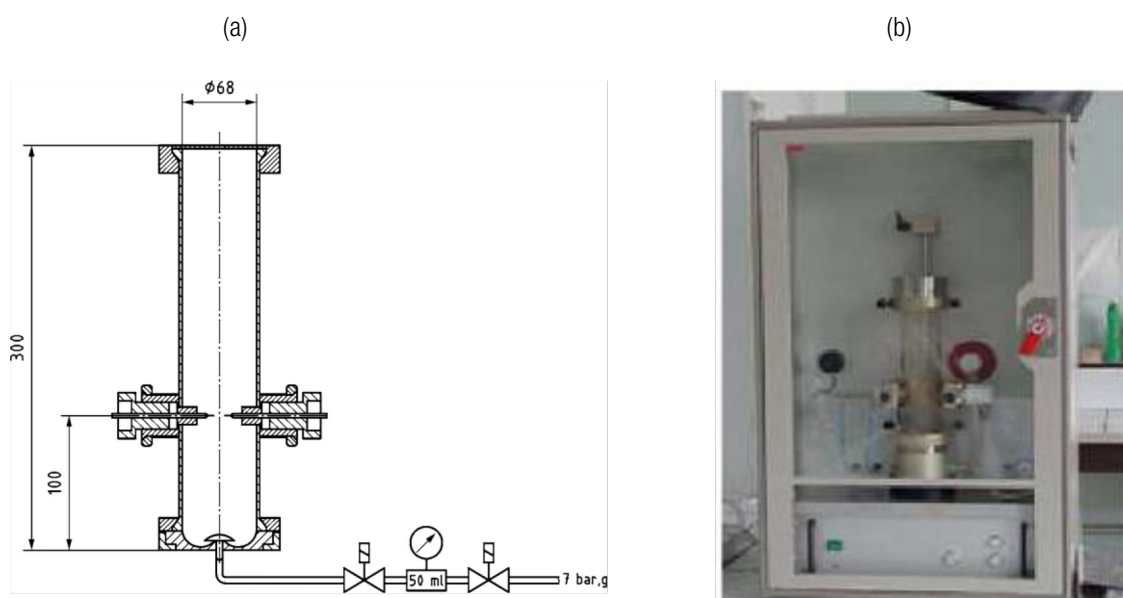
Figura 3- Tubo di Hartmann modificato: rappresentazione schematica (a) e fotografia dell'apparecchio Kuhner A. G. Switzerland (b)
