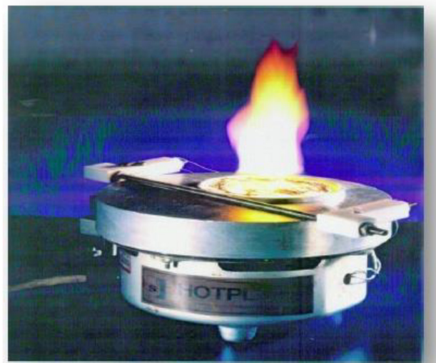
Figura 4 - Determinazione della MIT dello strato di polvere (prof. L. Marmo - Politecnico Torino).
