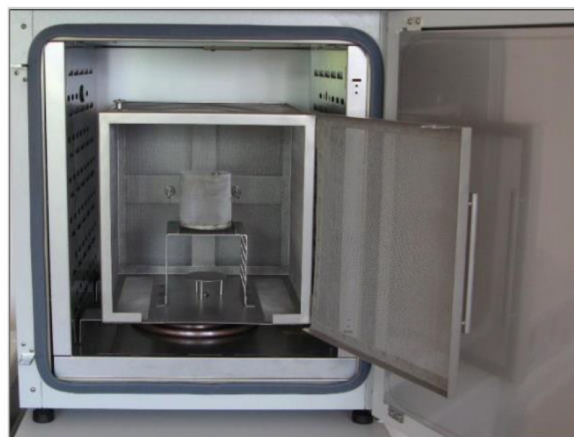
Figura 5 - Forno per prova secondo UNI EN 15188 (Anko).
