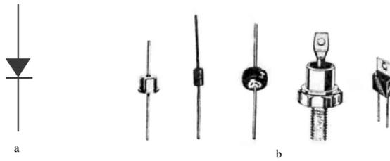
Figura 15.1 - Segno grafico generale (a) e aspetto esterno di alcuni tipi di diodi (b).
