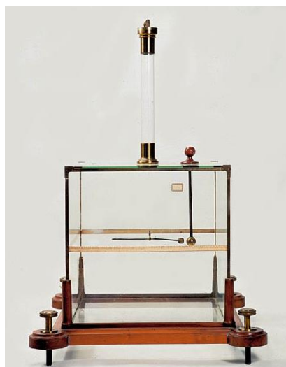
Figura 11 - Riproduzione della Bilancia di torsione ideata da Coulomb (Fondazione Scienza e tecnica-Firenze).
