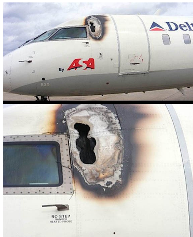
Figura 5 - Danneggiamento della fusoliera di un aereo causata da un fulmine.
