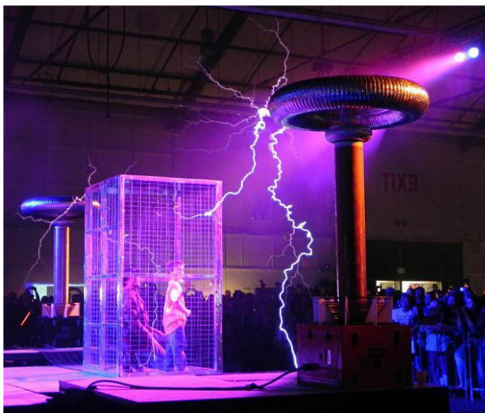
Figura 1 - Gabbia di Faraday per dimostrazioni didattiche.
