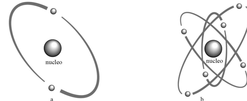
Figura 1.2 - Strutture atomiche dell'elio (a) e del carbonio (b). Per l'elio ruotano attorno al nucleo 2 elettroni su una sola orbita, mentre per il carbonio gli elettroni che ruotano sono 6 disposti su tre orbite di diverso diametro.
